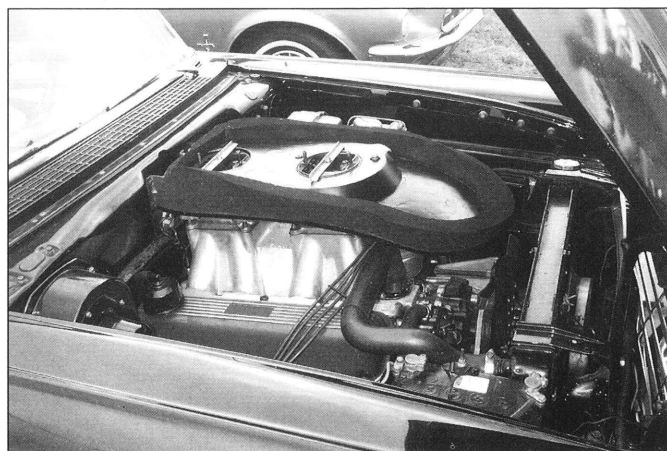
429 Cobra Jet i Fairlane -57 med tunnel raminsug och 720 hk
