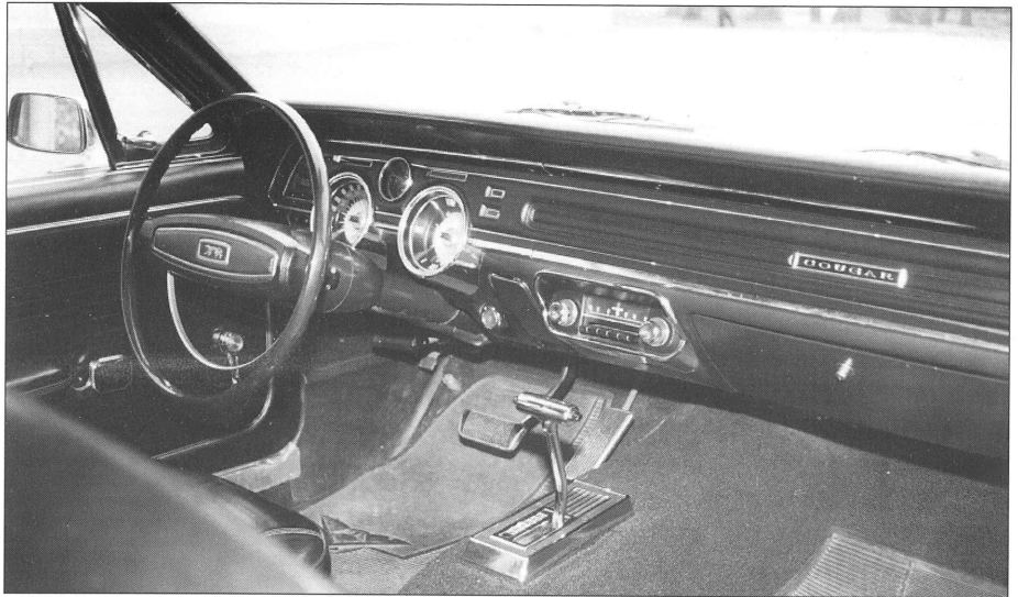
Instrumentbrädan är enkel i sin uppbyggnad, två stora mätartavlor dominerar. AM radion var extrautrustning.
