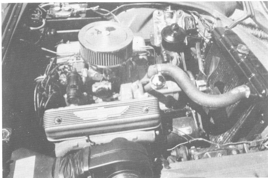
Första toppventilåttan var y-blockaren, här i Thunderbirdutförande.
